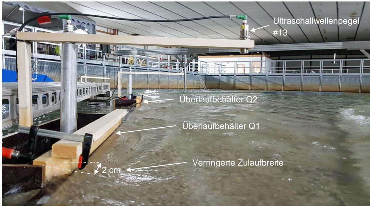
Abbildung 14: Verringerte Zulaufbreite an Überlaufbehälter Q1 für Versuche mit niedrigem Freibord (Wasserstand: +5,6 m NHN, Kronenhöhe: +6,5 m NHN).
