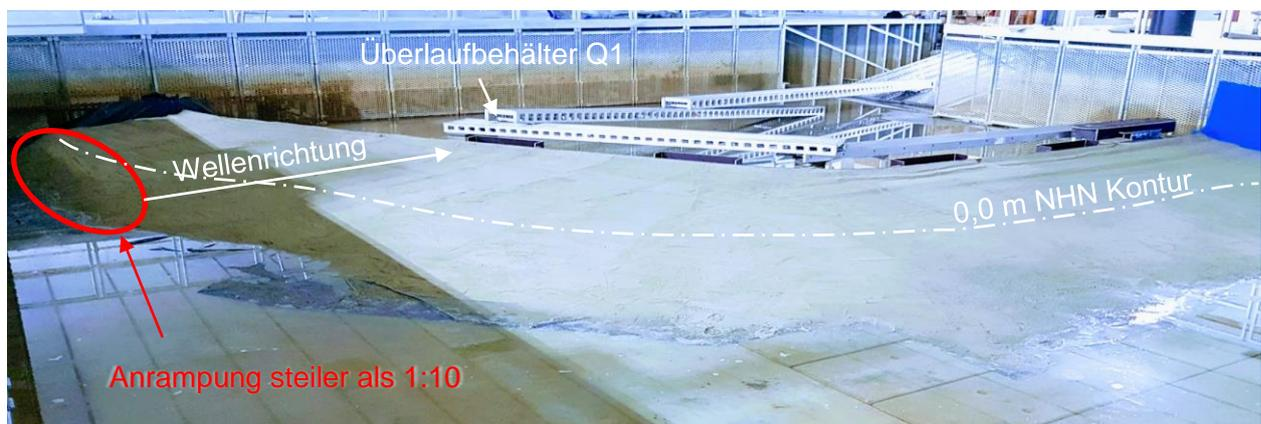
Abbildung 12: Steilere Neigung vor der Modellbathymetrie zwischen Profil 51+350 und 51+600.
