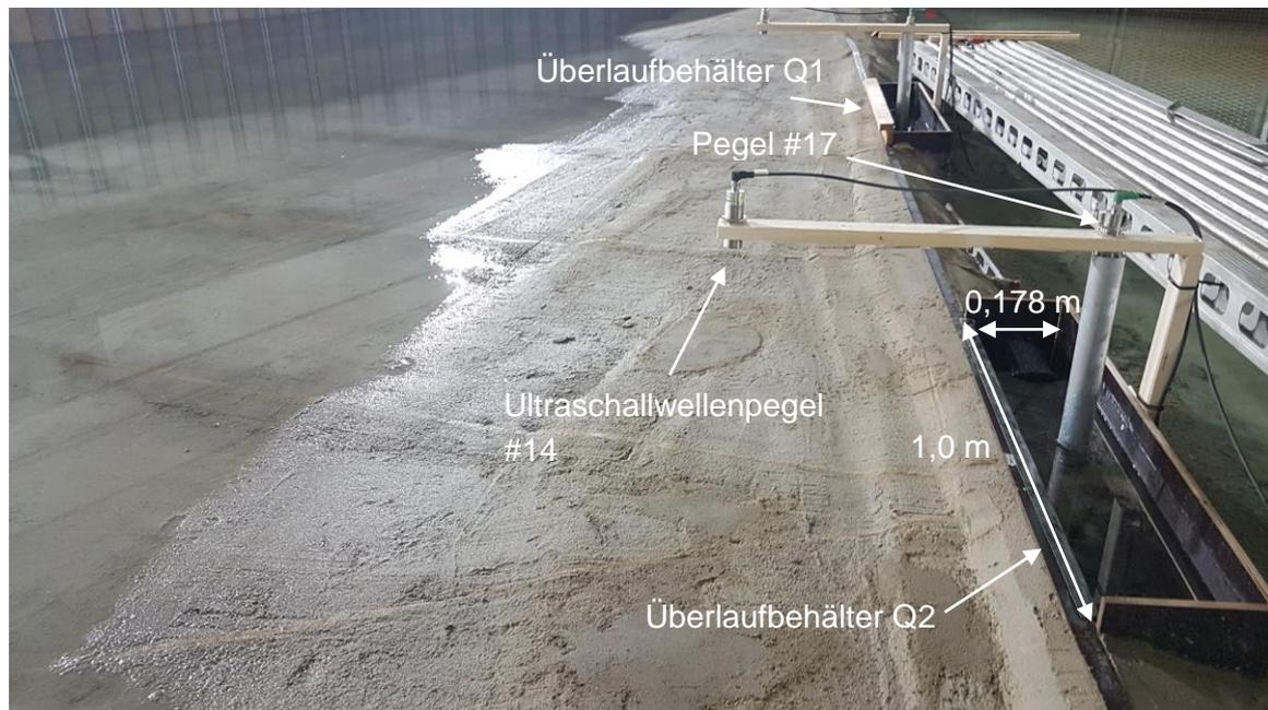
Abbildung 7: Überlaufbehälter Q2 mit vorgelagertem Ultraschallwellenpegel #14 und Pegel #17 im Behälter zur Messung der Änderung von Wasserständen.
